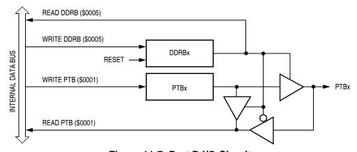
Figure 11-7. Port B I/O Circuit
